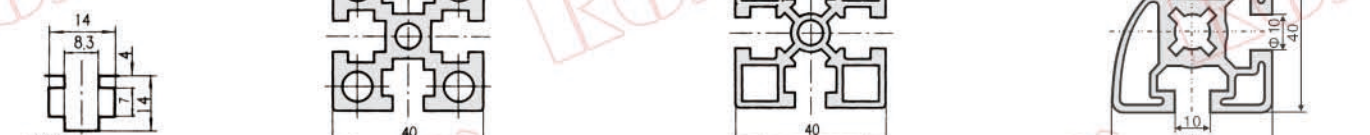
采购编号: 4040 理论重量: 2.02kg/m 采购编号: 4040L 理论重量: 1.43kg/m 采购编号: 4040R
